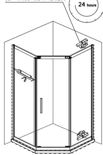
安装完成后,用中性玻璃胶把靠墙型材与墙壁间、石基与墙壁间、滑道与大理石间的缝隙密封(如图8虚线所示),待24小时玻璃胶完全干透后,方可放心使用。
